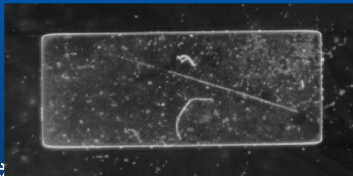
晶片检测：紫外光能将微小尘粒显示出来
